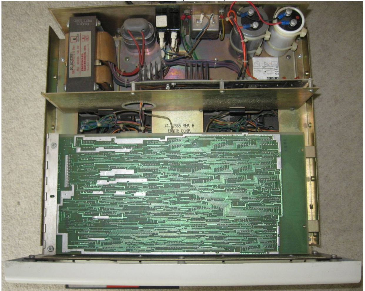
Bild 13 : Ansicht von oben , Controller Board ( Rückseite) und Netzteil.
