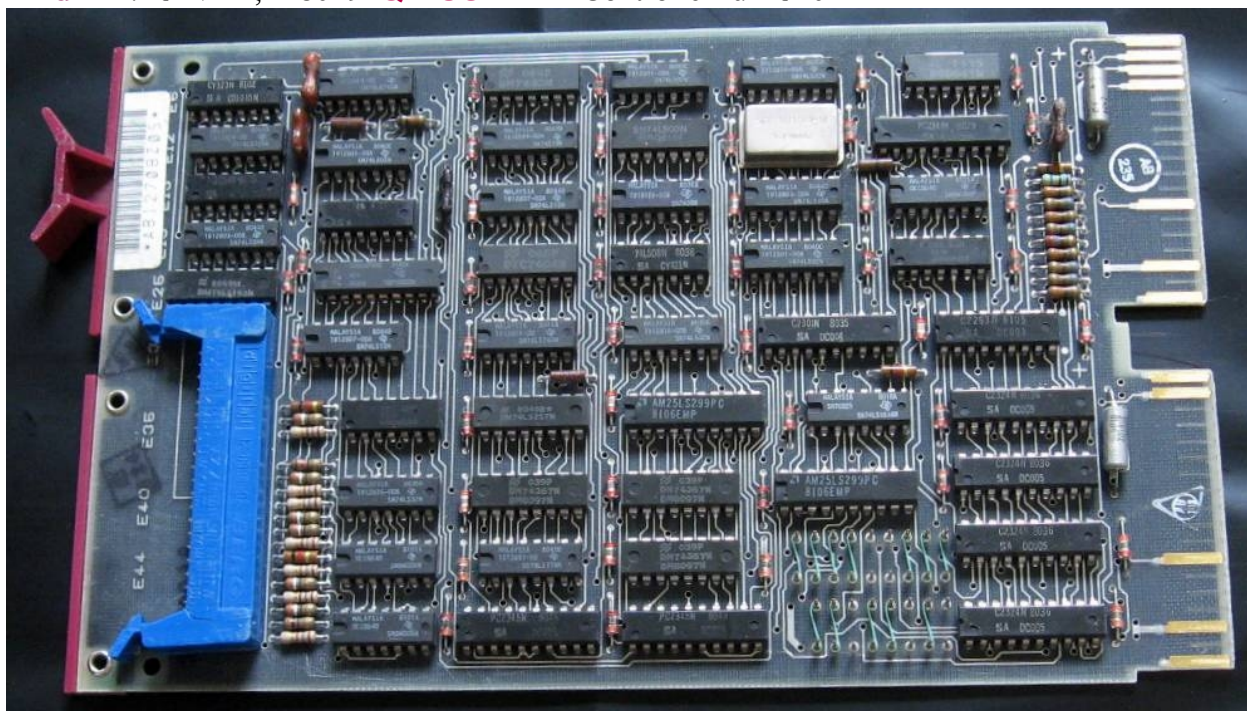
Bild 12 : RXV21 , M8029 Q-BUS DMA Controller für RX02
